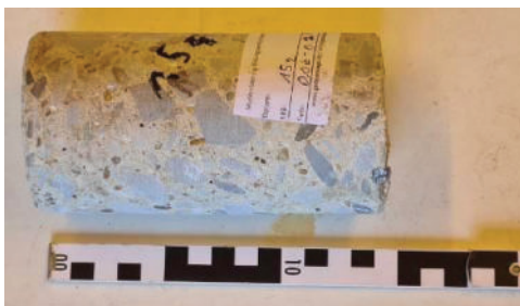
Foto 8: Bohrkern KRB 15 ab 0,06 m (Halle 3)
